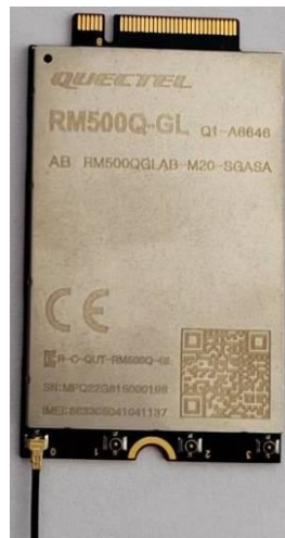
Figure 2-4 5G Module RM500Q-GL
